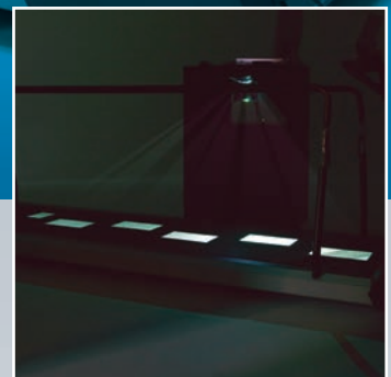
Projection d'objets lumineux sur le tapis de marche: pavés lumineux
